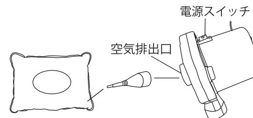
3. 空気排出口にノズルを付けて空気を抜きます。
