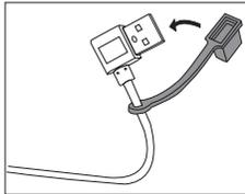
本製品を洗濯する前に、必ずUSBカバーを取り付けてください。取り外した状態では洗濯しないでください。
