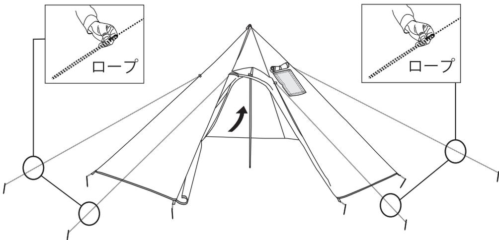
② ポールを組み立て、テント本体の中心に差し込みます。最後にロープ4本を4箇所、ペグで固定します。
