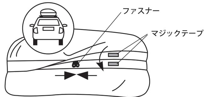
④ルーフバックのファスナーを引いて、バックを閉めてください。最後にマジックテープ同士を貼り付けてください。
