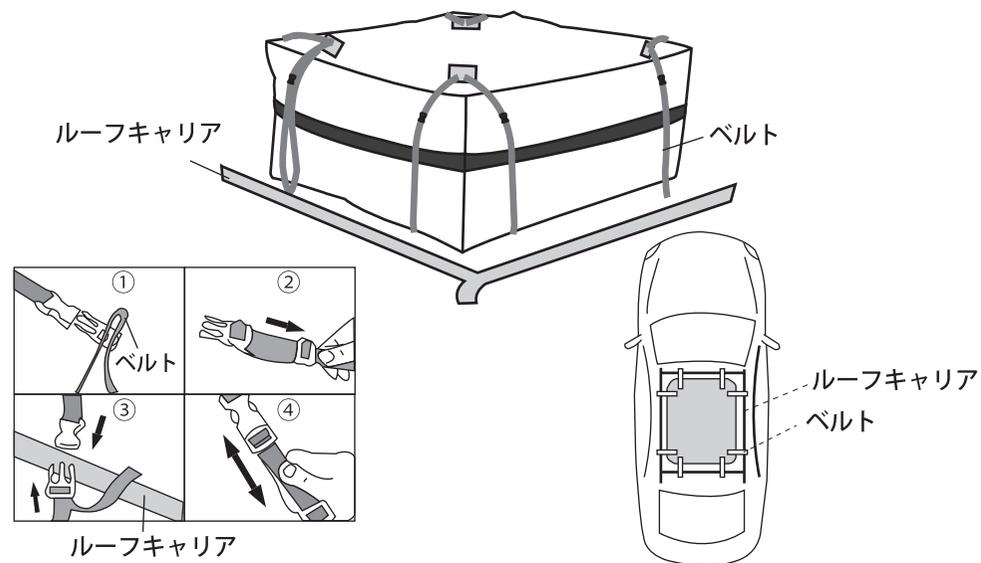
⑤ベルト(8本)をルーフキャリアを通して、バックルで固定します。最後にベルトの緩みが無いよう締めてください。
