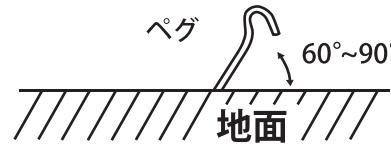
ペグは左図のように地面から $60^{\circ}\sim90^{\circ}$ の角度で打ち込みますと、風に対して強く設営できます。
