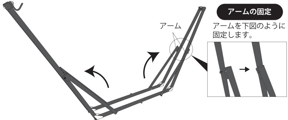
①フレームを起こし、傾き調節の4つのアームを立ててフレームに固定します。
