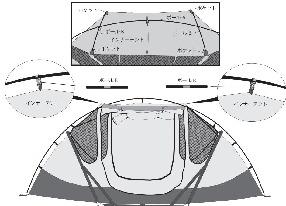
④ポールB 2本を上図のようにフックの穴に通し、両側のポケットに挿入します。
